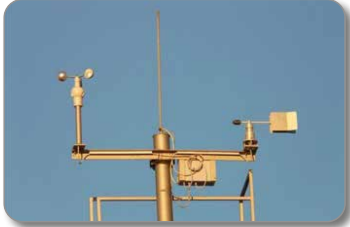
Görsel 2.1.11: Rüzgâr ölçümü yapan anemometre ve bileşenleri
