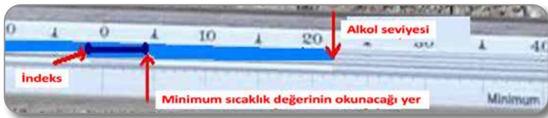
Görsel 2.1.8: Minimum termometrenin okuma şekli
